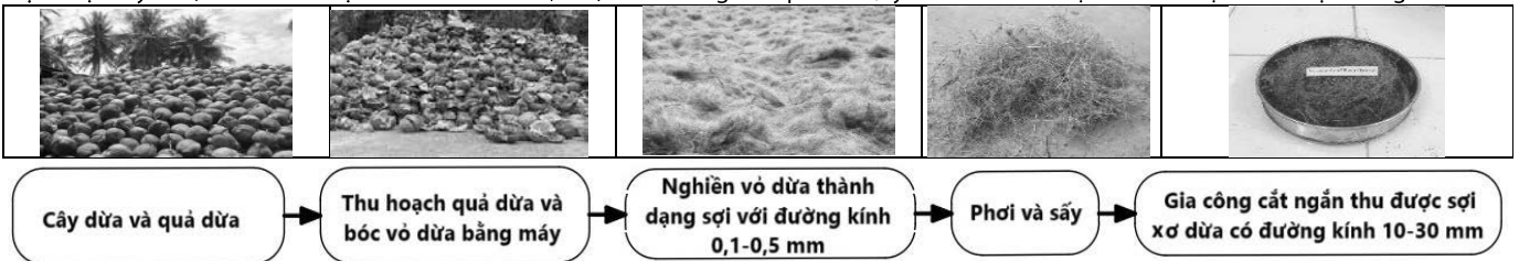
Hình 3. Sơ đồ công nghệ chế tạo sợi xơ dừa từ vỏ dừa
