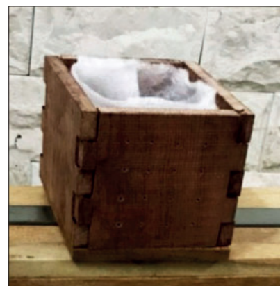
Рис. 4. Перфорированная форма для получения ячеистого бетона переменной плотности Fig. 4. Perforated form for obtaining cellular concrete with variable density
