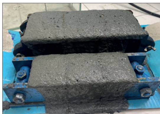
Рис. 2. Выход уложенной пенобетонной смеси за границы форм в результате продолжающегося роста объема пеномассы, приводящего к снижению качества пенобетона Fig. 2. Exit of the laid foam concrete mixture beyond the boundaries of the molds as a result of the continuing increase in the volume of foam mass, leading to a decrease in the quality of the foam concrete
