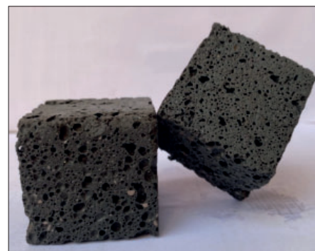
Рис. 9. Образцы-кубы размером 70×70×70 мм, выпиленные из наружного и внутреннего слоев образцов-кубов ячеистого бетона размером 150×150×150 мм
