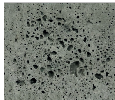
Рис. 5. Образцы-кубы размером 150×150×150 мм из ячеистого бетона и их внутренняя структура переменной плотности, видимая на поперечном распиле Fig. 5. Cube samples 150×150×150 mm in size from cellular concrete and their internal structure of variable density, which is visible on the cross-section
