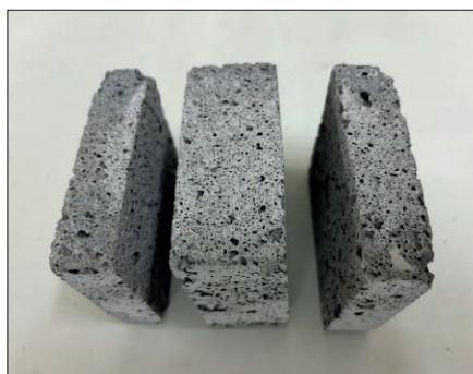
Рис. 5. Образцы-кубы размером 150×150×150 мм из ячеистого бетона и их внутренняя структура переменной плотности, видимая на поперечном распиле Fig. 5. Cube samples 150×150×150 mm in size from cellular concrete and their internal structure of variable density, which is visible on the cross-section
