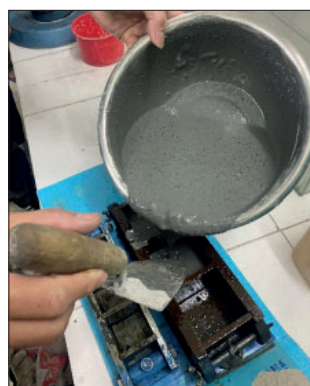
Рис. 2. Выход уложенной пенобетонной смеси за границы форм в результате продолжающегося роста объема пеномассы, приводящего к снижению качества пенобетона Fig. 2. Exit of the laid foam concrete mixture beyond the boundaries of the molds as a result of the continuing increase in the volume of foam mass, leading to a decrease in the quality of the foam concrete
