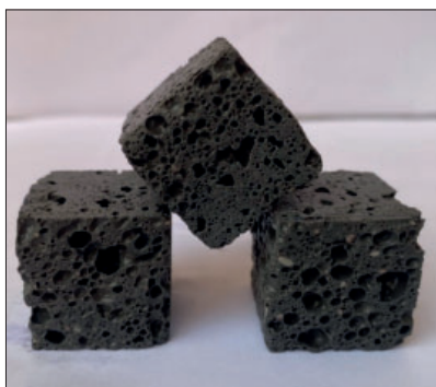
Рис. 9. Образцы-кубы размером 70×70×70 мм, выпиленные из наружного и внутреннего слоев образцов-кубов ячеистого бетона размером 150×150×150 мм
