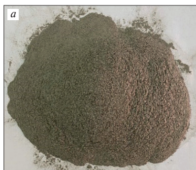
Рис. 6. Зола-уноса ТЭС «Вунг Анг» (а); тонкомолотый доменный шлак металлургического завода «Хоа Фат» (b) и керамический порошок «ТОТО» (с) Fig. 6. Fly ash from the Vung Ang thermal power plant (a); blast furnace slag from the Hoa Phat metallurgical plant (b) and TOTO ceramic powder (c)
