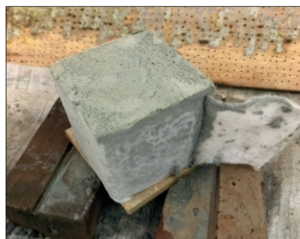
Рис. 5. Образцы-кубы размером 150×150×150 мм из ячеистого бетона и их внутренняя структура переменной плотности, видимая на поперечном распиле Fig. 5. Cube samples 150×150×150 mm in size from cellular concrete and their internal structure of variable density, which is visible on the cross-section
