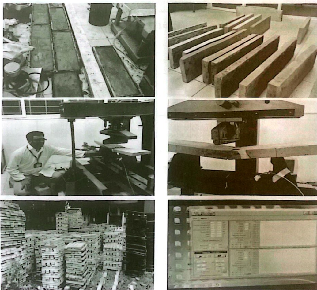
Hình 13. Quá trình chế tạo và thí nghiệm tấm chèn sử dụng tro bay thay thế xi măng tại Phòng thí nghiệm Xây dựng Công trình ngầm và Mỏ - Trường Đại học Mỏ-Địa chất
