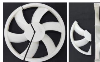
Fig. 3. Cross section of fan (hollow fan)
