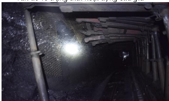
Hình 4. Trạng thái hoạt động thực tế của giá thủy lực di động tại lò chợ I-6-2
