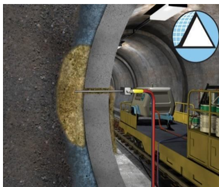
Hình 9. Giải pháp bơm ép vữa gia cường vỏ hầm
