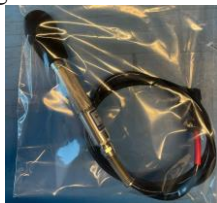
a. Microphone Blasmate III (Linear Mic) đo sóng đập không khí
