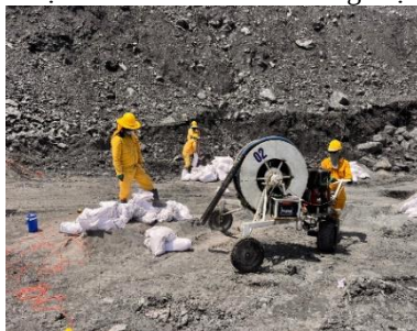
Hình 2. Công tác nổ mìn tại khu vực đất đá ngậm nước của mỏ than Đèo Nai
