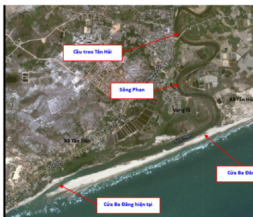
Hình 2. Hiện trạng cửa Ba Đăng hiện tại đang có nguy cơ bị bồi lấp
