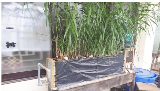
Hình 1. Hệ thống CW được trồng Ph. australis sử dụng cho xử lý nước ngầm nhiễm Benzen và MTBE.
