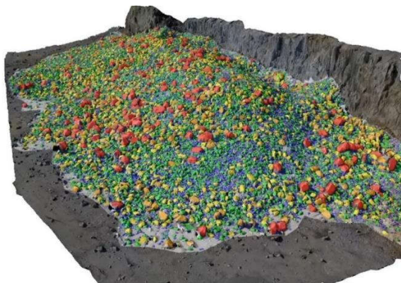
Hình 2. Ảnh 3D đồng đá nổ mìn được xây dựng từ ảnh UAV độ phân giải cao (N. J. M.L. Correia, 2020)
