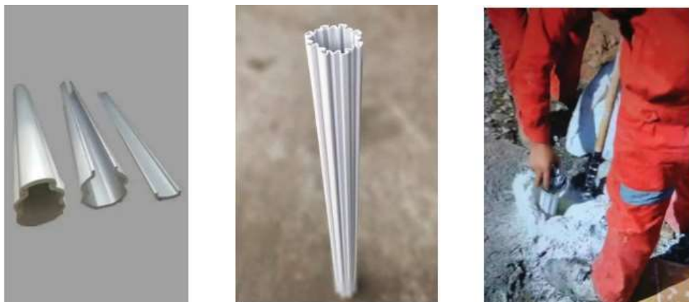
Hình 3. Hình ảnh ống tập trung năng lượng khi nổ mìn [11]
