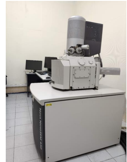
Hình 7: Thiết bị kính hiển vi điện tử quét NOVA NANOSEM 450, tích hợp detector EDS
