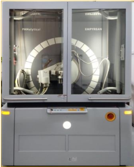
Hình 5: Thiết bị đo nhiễu xạ tia X PANalytical empyrean
