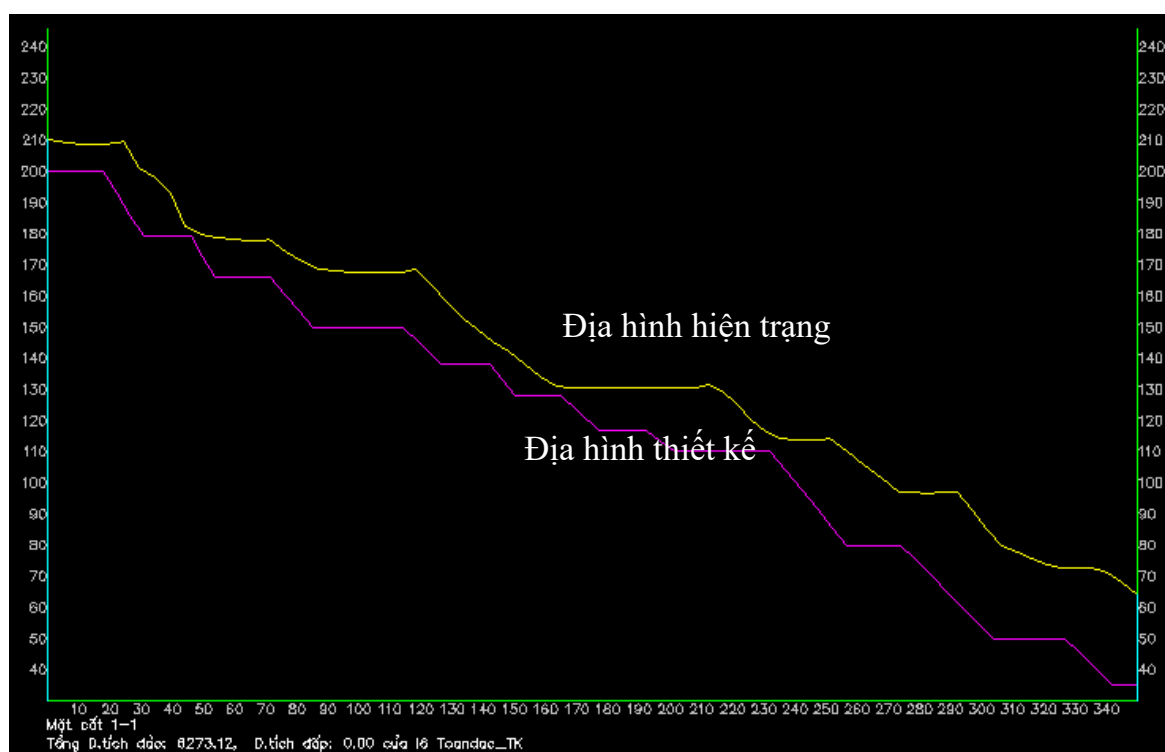
Hình 14. Mặt cắt tính khối lượng theo số liệu đo bằng máy toàn đạc điện tử
