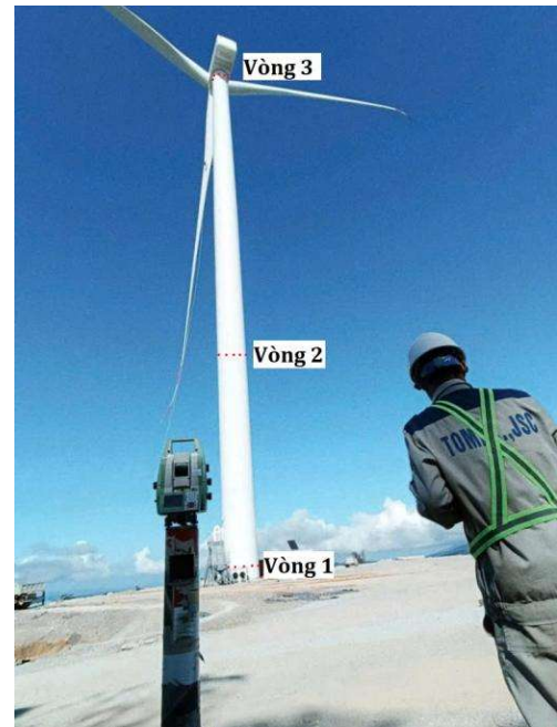
Hình 7. Đo tọa độ trên các vòng đai trụ điện gió bằng máy toàn đạc điện tử không gương (ảnh Tạ Minh Sơn, Đỗ Văn Mão)
