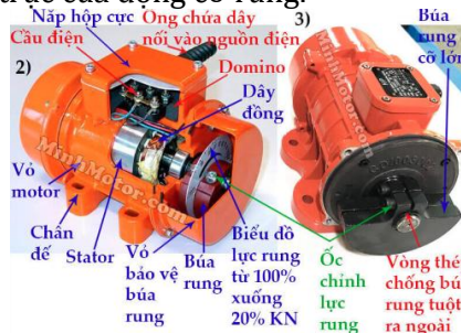
Hình 2. Động cơ rung
