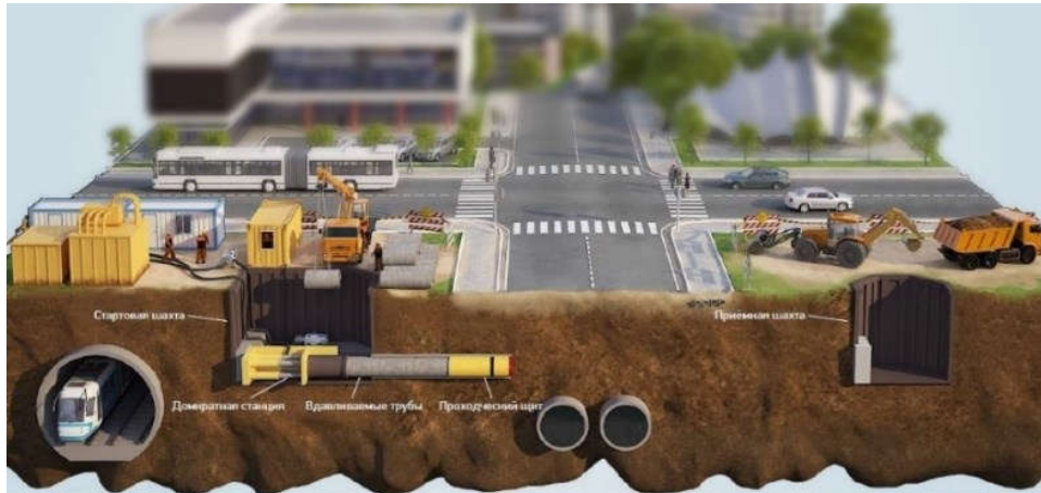
Hình 2. Sơ đồ công nghệ phương pháp kích đẩy (Herrenknecht AG).
