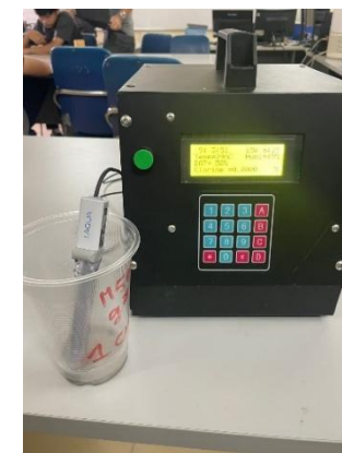
Thí nghiệm đo ion Clo TCVN 12041:2017
