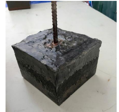
Hình ảnh mẫu bọc sau khi thực hiện thí nghiệm đẩy nhanh ăn mòn
