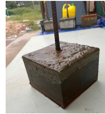
Hình ảnh mẫu bọc sau khi thực hiện thí nghiệm đẩy nhanh ăn mòn
