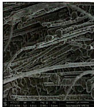
Hình 3: Ảnh SEM của dây nano CuO/Au gia nhiệt sau khi phun xạ
