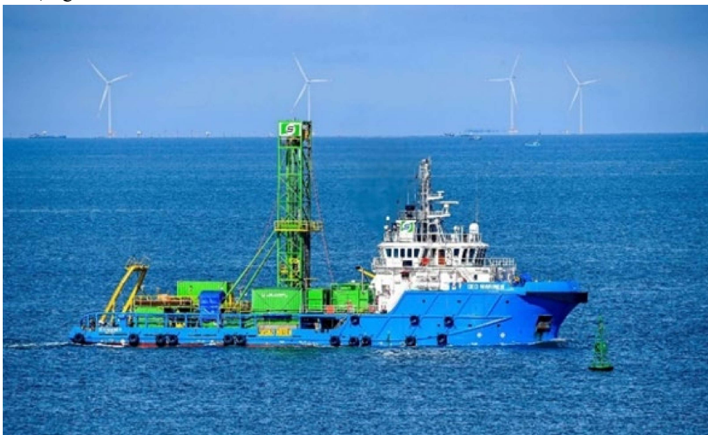
Hình 2. Tàu khoan chuyên dụng trang bị hệ thống định vị động học DP2 và giàn khoan ĐCCT
