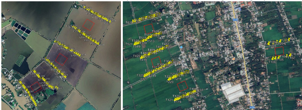
Hình 2. Bố trí tuyến đo, điểm đo và khung dây phát (khung màu đỏ) tại Long An và Trà Vinh
