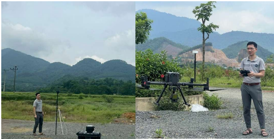
Hình 7. Trạm điều khiển mặt đất GNSS (trái); Tiến hành bay UAV (phải)
