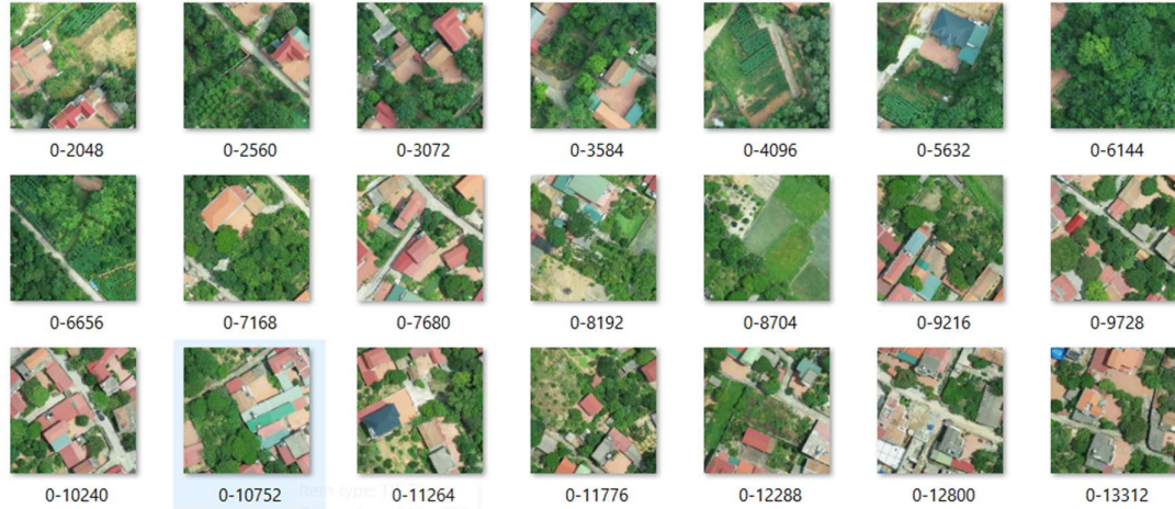
Hình 9. Các mẫu tiles được chia nhỏ từ một tấm ảnh UAV ortho lớn
