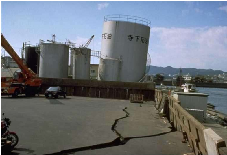
Hình 4. Bể chứa bị nghiêng tại kho chứa dầu Karumojima do sự trượt ngang của mặt đất bị hóa lỏng (Christovasilis, 2006).
