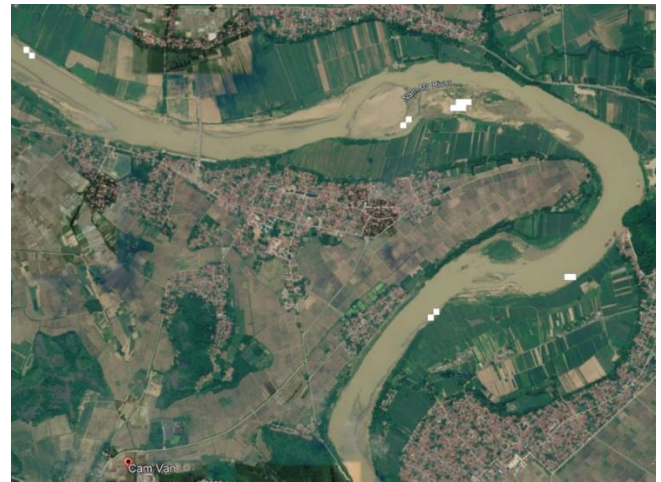
Hình 7. Kết quả xác định sạt lở bờ sông Mã tại khu vực Cẩm Thủy sử dụng ảnh vệ tinh Landsat
