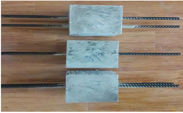
Hình 3. Sơ đồ mẫu thử kéo nhỏ xác định lực bám dính cốt thép
