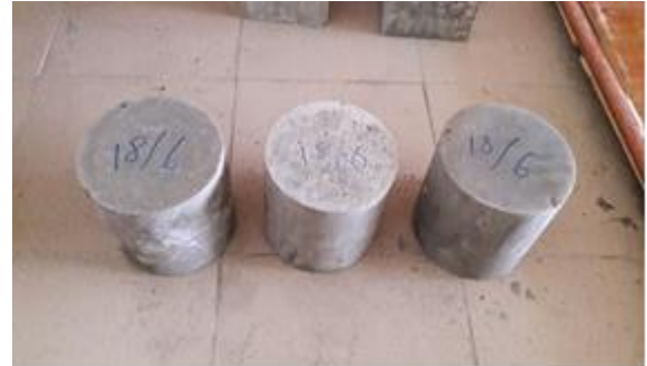
Hình 4. Mẫu thử xác định khả năng chống thấm nước
