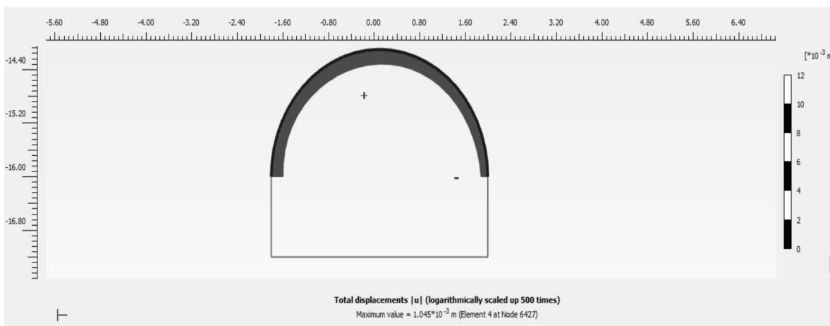
Hình 25. Biến dạng lớn nhất của biên đường lò tại khu vực vòm khi chịu ảnh hưởng của vụ nổ tại đường lò lân cận
