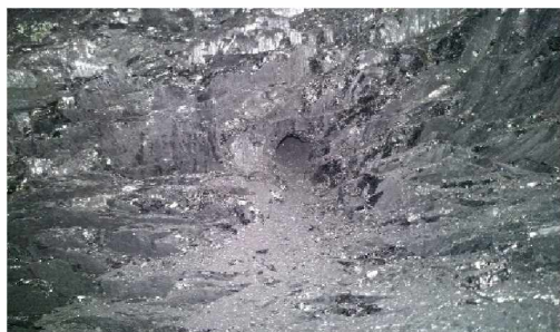
Hình 6. Hình ảnh than liên kết rắn chắc sau bơm ép nước vào gương lò chợ 14.5-12.5
