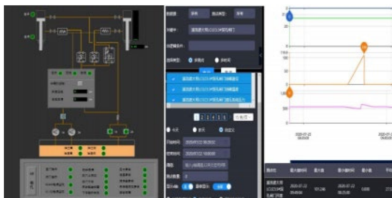
Hình 5. Giao diện dashboard giám sát biến dạng theo thời gian thực trên nền tảng đám mây, hiển thị giá trị cảm biến và cảnh báo vượt ngưỡng [11].
