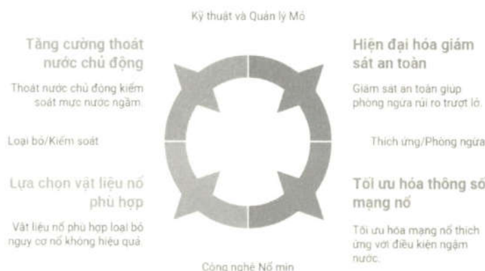
Hình 9. Giải pháp kỹ thuật đồng bộ nâng cao hiệu quả nổ mìn cho mỏ lộ thiên sâu
