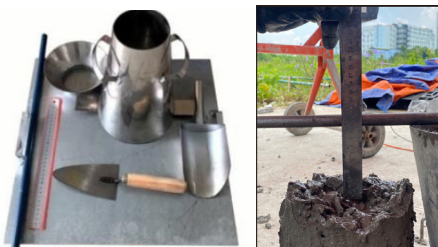
Hình 2. Bộ côn hình nón cắt tiêu chuẩn kích thước 10 × 20 × 30 cm
