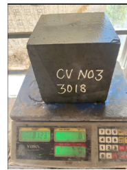
Hình 3. Mẫu bê tông kích thước 150 × 150 × 150 mm
