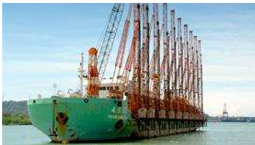
Hình 1. Tàu khoan lỗ mìn Yuan Dong 007 với 10 tháp khoan đang thi công cải tạo kênh đào Panama
