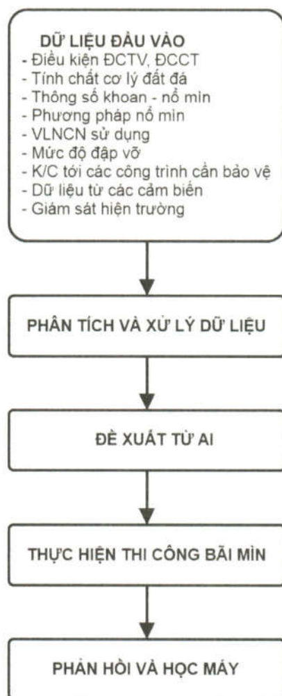
Hình 2: Nguyên lý hoạt động hộ chiếu nổ mìn theo thời gian thực
