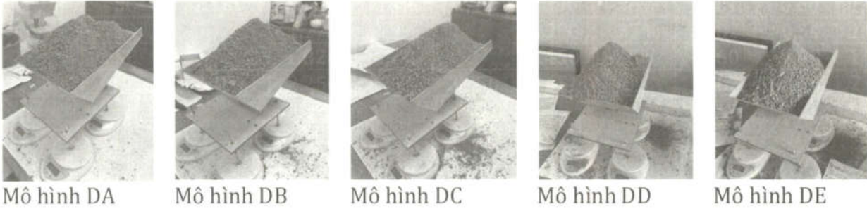
Hình 10. Mô hình chất tải thí nghiệm với đá dăm (tương đương đất đá thải phân tầng trên)
