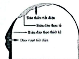
Hình 1.8. Biên đào thiết kế và biên đào thực tế trong quá trình đào lò bằng phương pháp khoan nổ mìn
