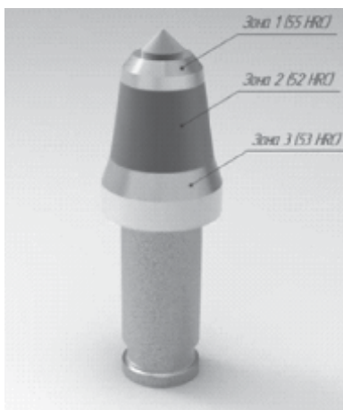
Hình 4. Yêu cầu độ cứng bề mặt thân răng cắt phá hủy đất đá
