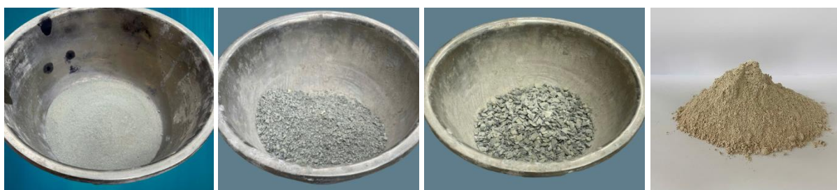
a) Quặng sắt Ilmenite kích thước hạt 0,14÷5,0 mm
