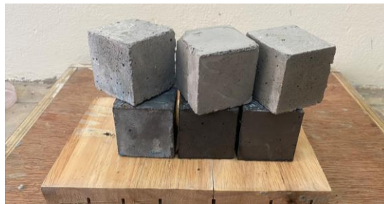
Hình 5. Mẫu bê tông hạt mịn siêu nặng cần xạ
