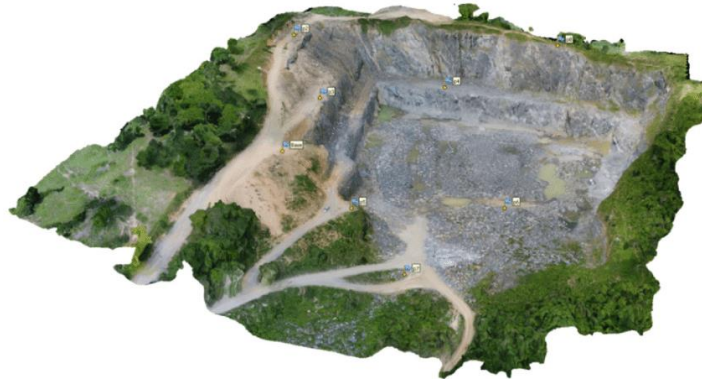
Hình 1. Mô hình địa hình mỏ xây dựng từ ảnh chụp UAV ở độ cao 80m (J. M.L. C. Neto, 2020)
