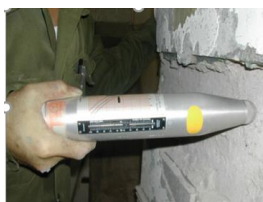
Hình 5. Phương pháp thí nghiệm kiểm định chất lượng bê tông công trình
