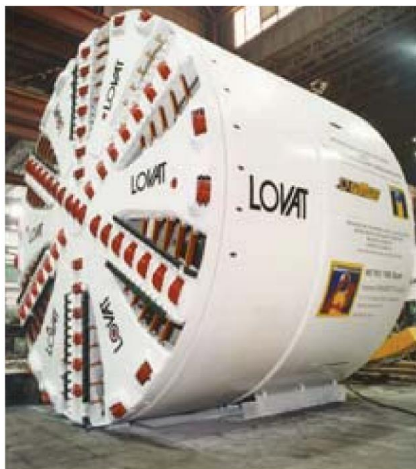
Hình 3.15. Khiên đào EPB do LOVAT sản xuất
