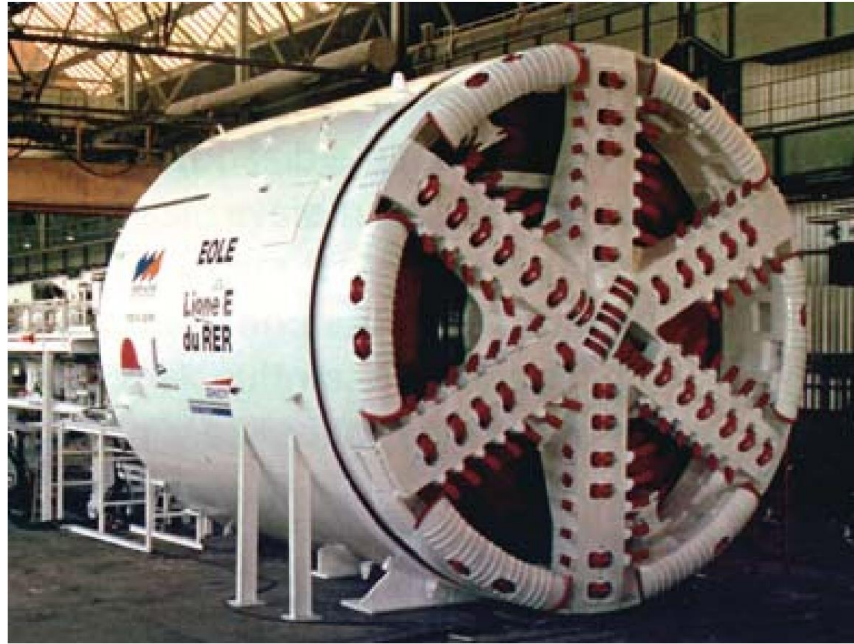
Hình 3.2. Hình ảnh tổng quan về máy đào hầm Voest Alpine Hydrosields
