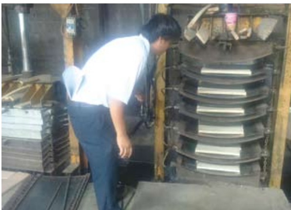
Hình 1: Thiết bị uốn cong gỗ nhiều tầng
