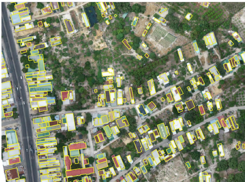
Hình 0-2: Lớp nhà được số hóa (vector) sử dụng làm đối tượng thực để testing
