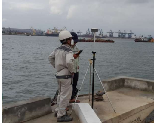
Hình 1-3: Ví dụ về đo điểm khống chế tọa độ và độ cao bằng công nghệ GNSS tại khu vực Bình Sơn, tỉnh Quảng Ngãi
