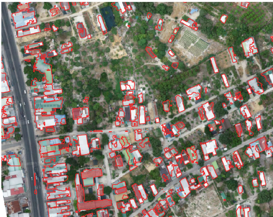
Hình 0-3: Kết quả dự đoán từ mô hình Unet
