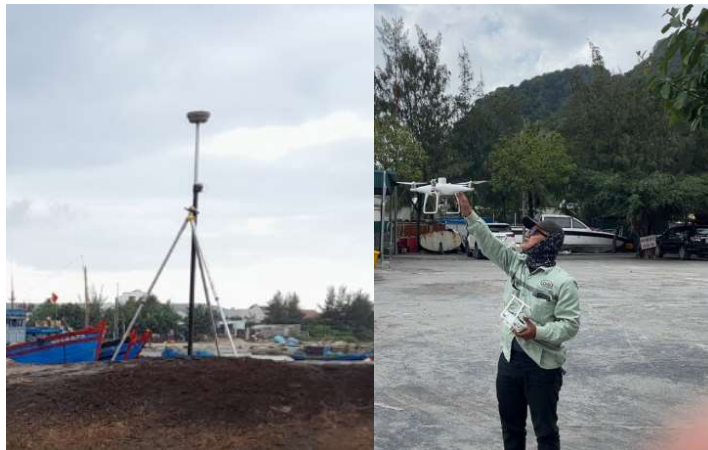
Hình 1-4: Trạm điều khiển mặt đất GNSS (trái); Tiến hành bay UAV (phải)
