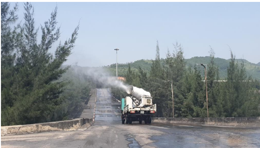
Hình 3.2. Vận hành thiết bị phun sương dập bụi cao áp và xe tưới đường chuyên dụng của Công ty CP Than Cao Sơn
