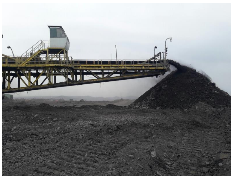
Hình 2.5. Tuyển băng tải đá đang hoạt động tại mỏ than Cao Sơn [16]
