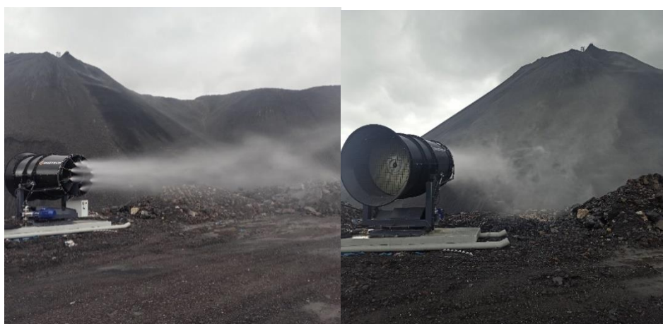
Hình 3.1. Súng phun sương dập bụi khu vực bãi thải Bàng Nâu
