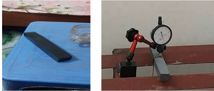
Hình 10. Gia công mẫu và đặt tải, đồng hồ đo chuyển vị tại giữa dầm
