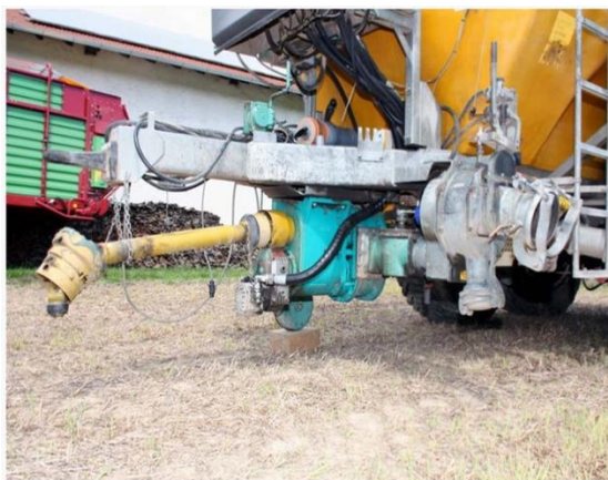
Hình 1. 5 Bơm thủy trong xe phun phân bón hữu cơ di động
