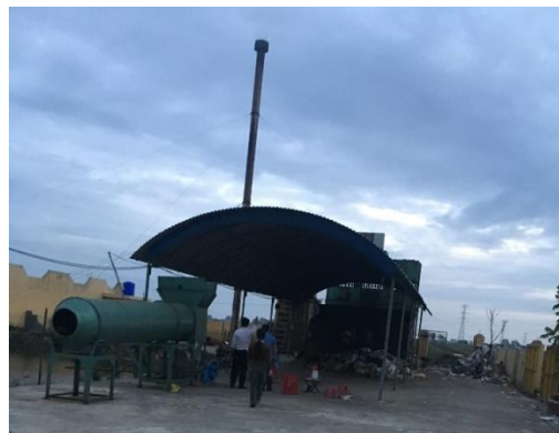
Hình 3.7. Mô hình xử lý chất thải bằng lò đốt nhiệt phân có xử lý khí thải bằng hấp thụ kết hợp chôn lấp hợp vệ sinh của Công ty TNHH Tân Thiên Phú tại xã Xuân Ninh, huyện Xuân Trường, tỉnh Nam Định
