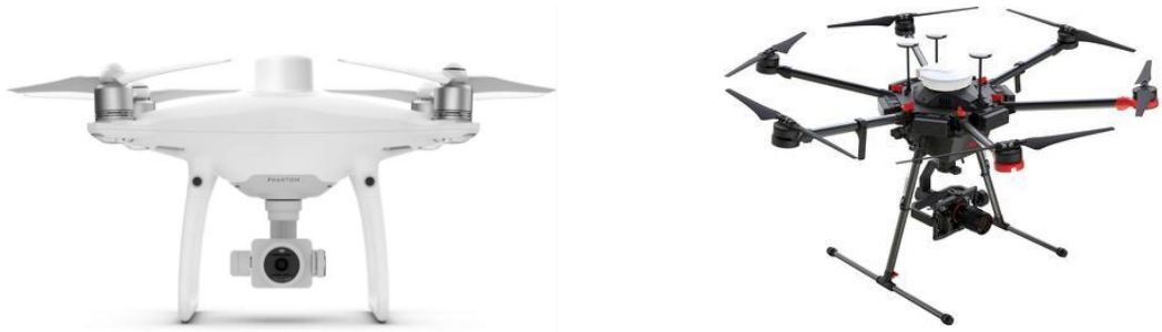
Hình 2 UAV có tích hợp GNSS động (UAV/RTK)
