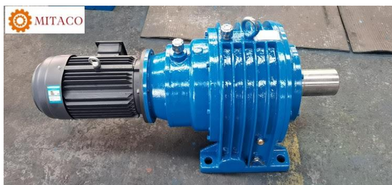
Hình 1-9 Hộp giảm tốc dùng trong giao thông
