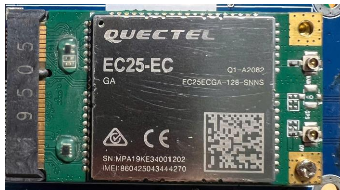
Hình 16. Module EC25 định hướng cho cảnh báo khẩn cấp
