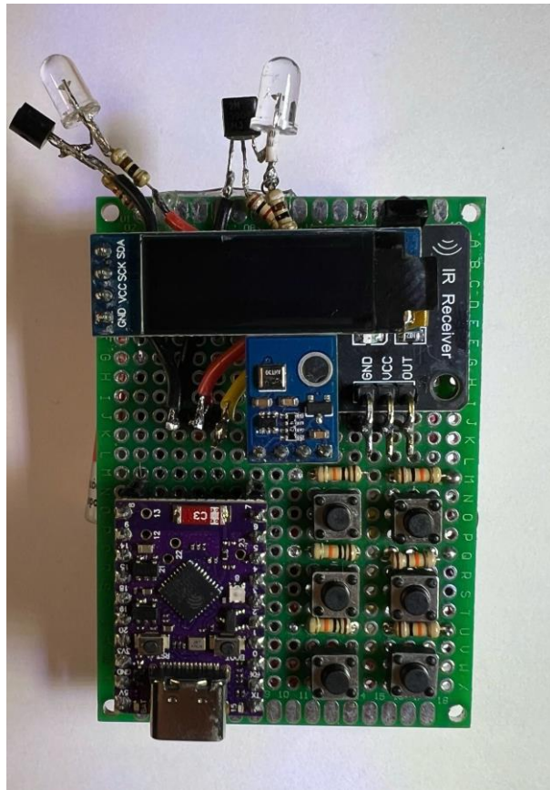
Hình 12. Node điều khiển IR và cảm biến môi trường
