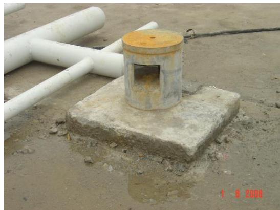
Hình 3.4: Mốc quan trắc dạng cột bê tông ống sắt
