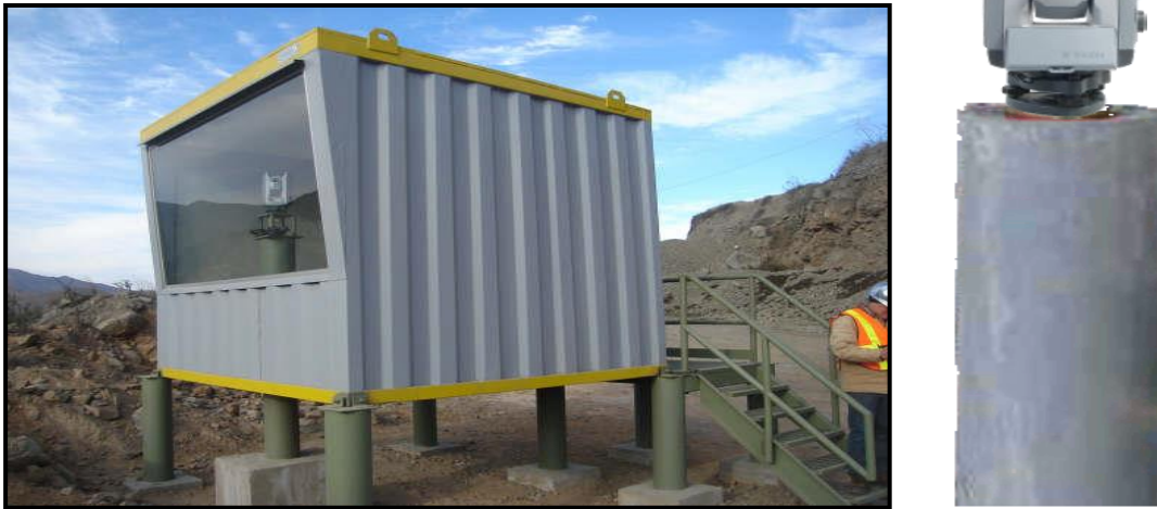
Hình 2.16. Trạm máy chủ (Base)
