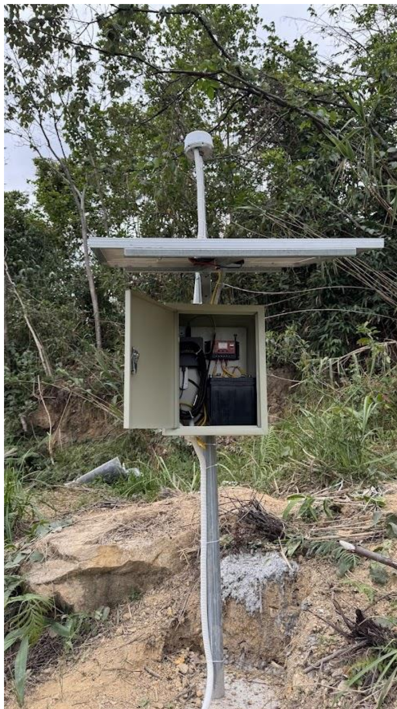
Hình 4.3: Thiết bị đo Quan trắc GNSS HK01
