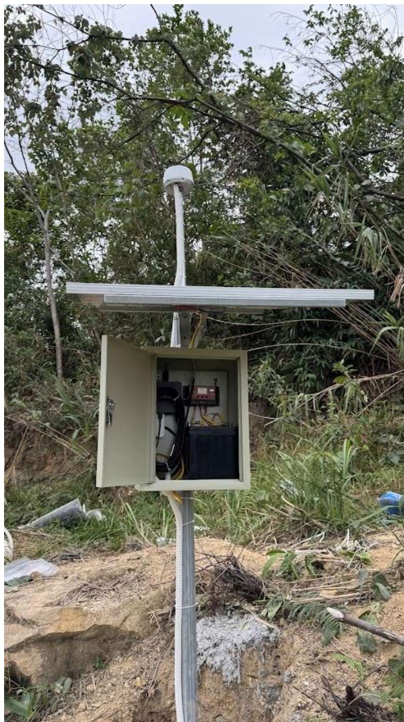
Hình 4.4: Thiết bị đo Quan trắc GNSS HK02
