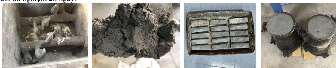
a) Máy trộn bê tông b) Bê tông sau khi trộn c) Mẫu 40x40x160 d) Mẫu hình trụ
