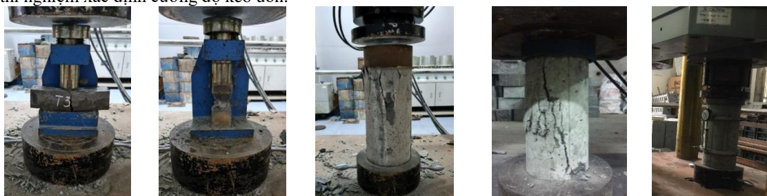
a) Thí nghiệm kéo uốn và nén trên mẫu 40x40x160 mm b) Thí nghiệm kéo uốn và nén trên mẫu 40x40x160 mm c) Thí nghiệm nén trên mẫu 150x300 mm d) Dạng phá hủy mẫu e) LVDT vòng đo biến dạng
